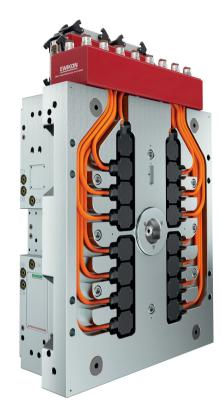
Für seine Elektro-Nadelverschlusssysteme verwendet Ewikon ab sofort eine neue Generation kompakter Linear-Servomotoren © Ewikon
